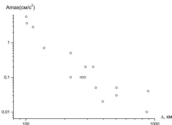
Рисунок 12. Зависимость максимальных амплитуд сильных движений от расстояния для землетрясений с магнитудами  $mb \sim 5$
