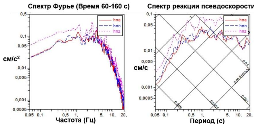
*Рисунок 7. Спектры Фурье и реакции землетрясения 24.05.2013 г., станция MAKZ*
