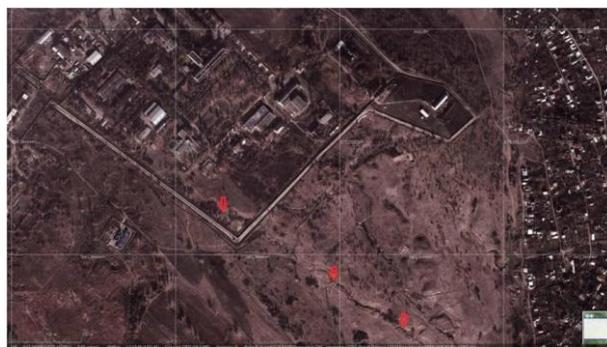
Рисунок 6. Космический снимок высокого разрешения с местоположением тектонической трещины-разлома в районе площадки реактора
