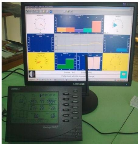
Рисунок 8. Метеостанция (слева) и пульт метеостанции рядом с компьютером сбора метеоданных (справа)
