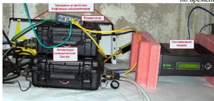
в – дигитайзеры, зарядное устройство и спутниковый модем
