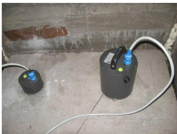
а – сейсмометр и акселерометр (без защитных кожухов)
