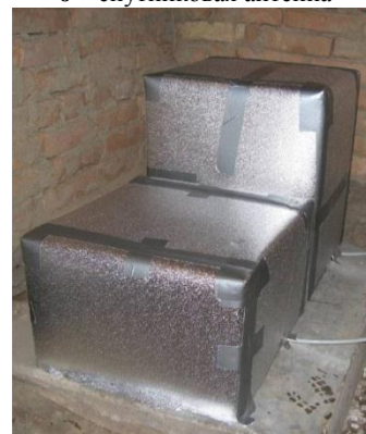
г – защитный кожух для сейсмометров
