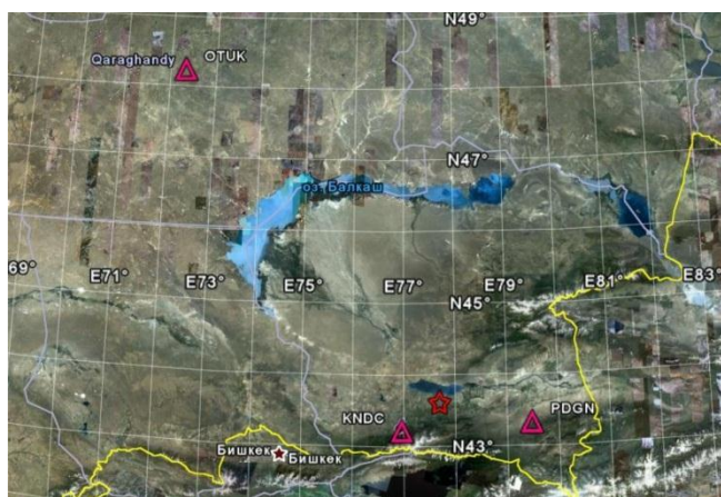
а – расположение станций относительно эпицентра землетрясения
