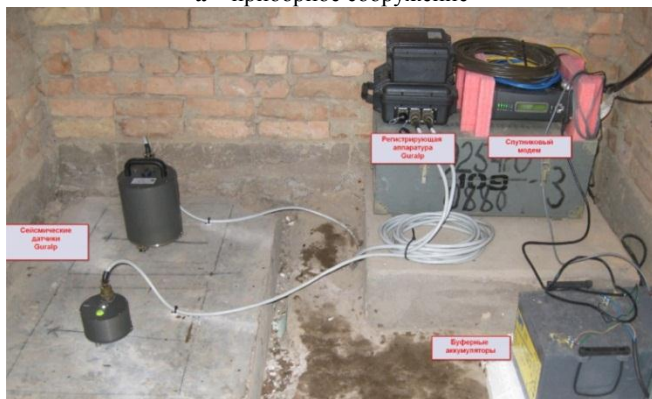
в – сейсмометры (акселерометр CMG-5T - слева, CMG-3ESPC – справа) и регистрирующая аппаратура
