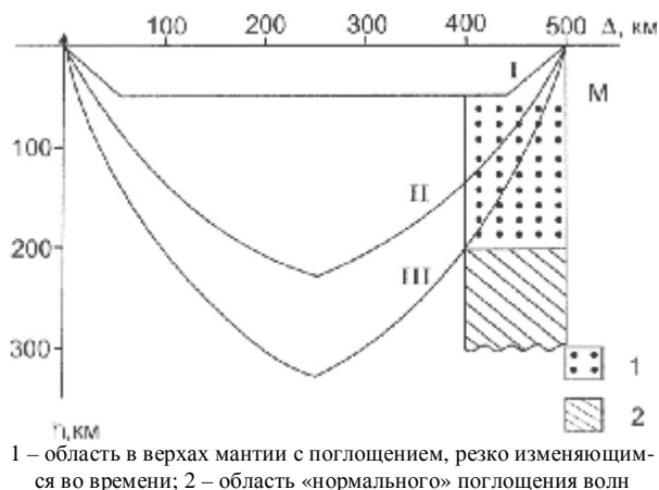
Рисунок 1. Схема распространения лучей, формирующих коду Lg
